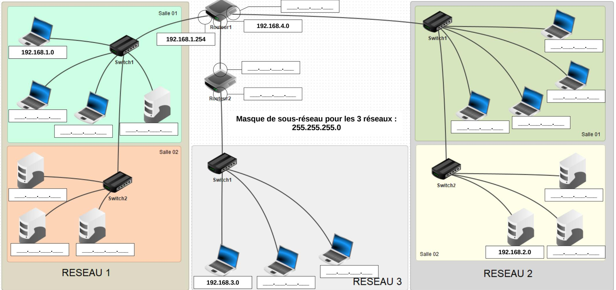
2- Compléter ci-dessous les masques de sous-réseau et les passerelles pour chaque PC des réseaux 1, 2 et 3 :
